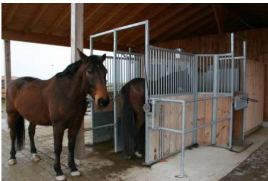
Fot. 10.13 Aparat do zadawania paszy HIT AktivStall® w Kastensee (Niemcy). Koń stojący na stanowisku paszowym próbuje „wyludzić” od automatu paszę, która w tej chwili mu się nie należy. Świadczy o tym otwarta bramka stanowiska (za zadem konia). z prawej strony stanowiska – wyjście dla konia po zjedzeniu paszy. Fot. J. Łojek
